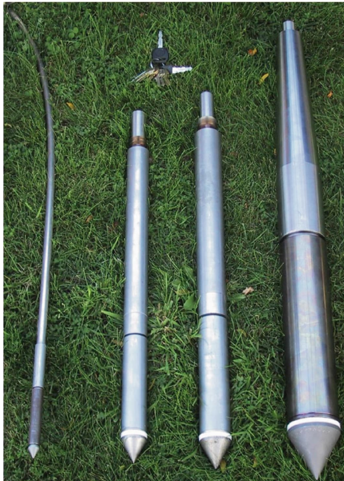
Figura 8. Gama de sondas CPT (de izquierda a derecha: 2 cm 2 , 10 cm 2 , 15 cm 2 , 40 cm 2 )
