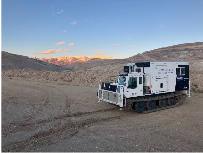
Figura 11. Unidad CPT montada sobre orugas de 200kN
